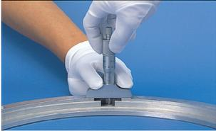
Die Abbildung zeigt als Beispiel eine Bügelmessschraube für die Tiefenmessung.
