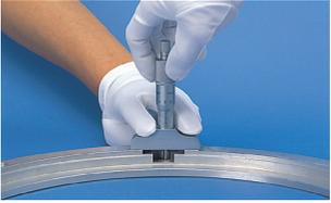
La imagen muestra un micrómetro de profundidad como ejemplo
