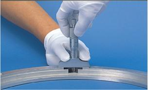
L'instrument représenté sur l'illustration est un micromètre de profondeur.
