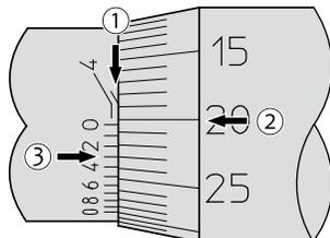
La valeur de « 0,20 mm » lue au point ②, correspond à l'intersection entre la ligne de référence de la douille graduée et la ligne de graduation du tambour.
