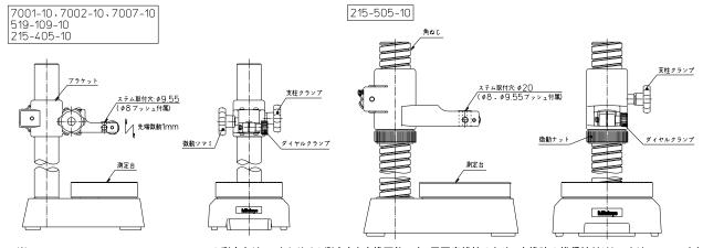
※7001-10、7002-10、7007-10、519-109-10 の測定台は、アクセサリの測定台と交換可能です。平面度維持のため、交換時の推奨締付けトルクは 80N・cm となります。 その他の機種の測定台も取り外しは可能です、再取り付けの際の推奨締付けトルクは 150N・cm となります。
