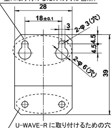
U-WAVE-R への取り付け図 (3 箇所に取り付け可能)
