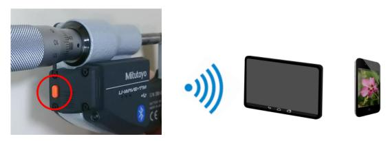
送信が成功すると LED が緑色に点滅します。ブザータイプの場合はブザーが 2 回鳴ります。 送信が失敗すると LED が赤色に点滅します。ブザータイプの場合はブザーが 1 回鳴ります。
