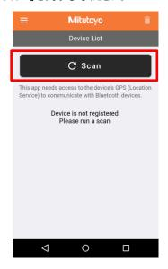
③ 下記画面が表示されたら U-WAVE-TCB/U-WAVE-TMB の DATA ボタン (オレンジ色) を押してください。
