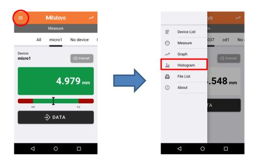
② 「Histogram」の画面が表示されたら「Select Device Name」をタップし、ヒストグラムを表示したいデバイスを選択してください。
