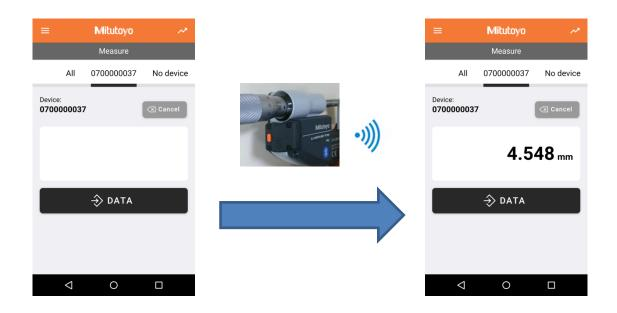
U-WAVE-TCB/U-WAVE-TMB が複数接続されている時は、「All」画面で全てのデバイスの測定値を確認することができます。デバイスを登録していない場所は「No device」と表示されます。
