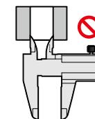
量測內徑時，使測量面貼合，並且在指針指示值為最大時（當連接測定面的直線穿過橫截面的中心時）讀值。
