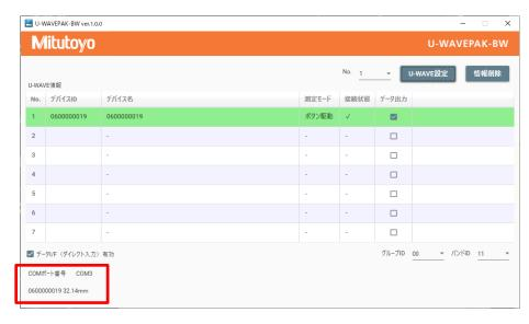
**Tips**・U-WAVE-TCB/U-WAVE-TMB の設定直後は、接続が成功しても測定値が送信されない場合があります。数秒間待機をしてから再度測定値を送信してください。
