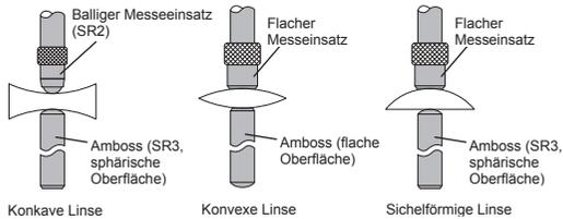
\* Parallelität zwischen flachem Messeinsatz und Amboss: 5 µm
