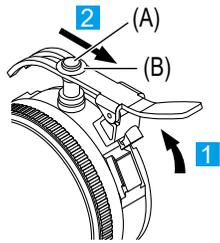
1 Die Spindel anheben und die Anschlagsschraube (A) zwischen den Spitzen des Anlifhebels anbringen.
